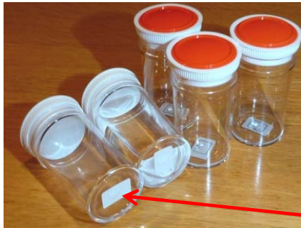
プラ試験瓶の底にタグを貼る
