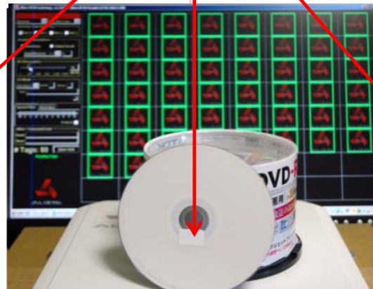
DVD メディアのハブにタグを貼る。アンテナの上にメディア 50 枚を重ねて、タグを一括で読むことができる。ハンディリーダーでメディアの側面からも読める
